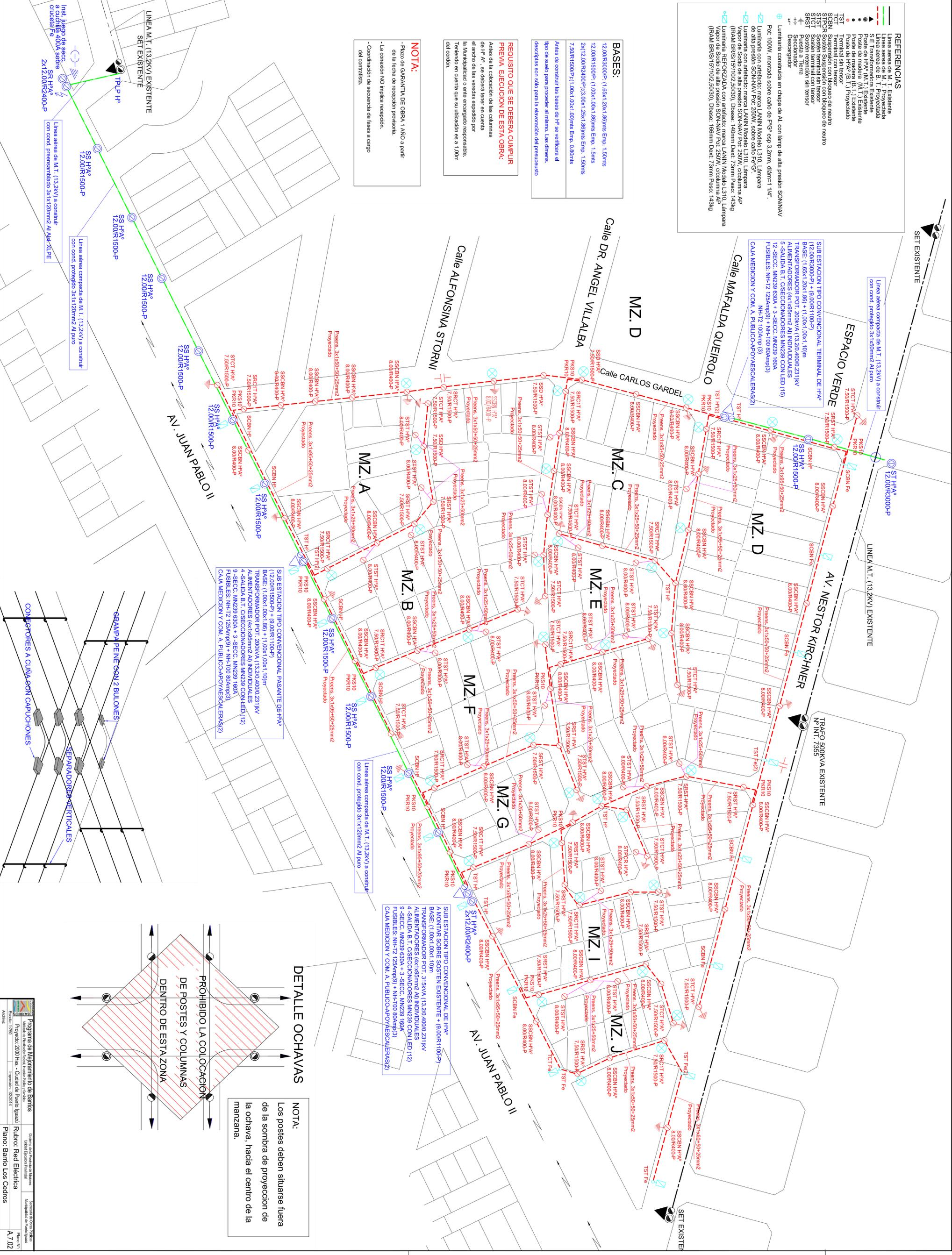
Linea aérea compacta de M.T. (13.2kV) a construir con cond. protegido 3x1x120mm<sup>2</sup> Al puro
