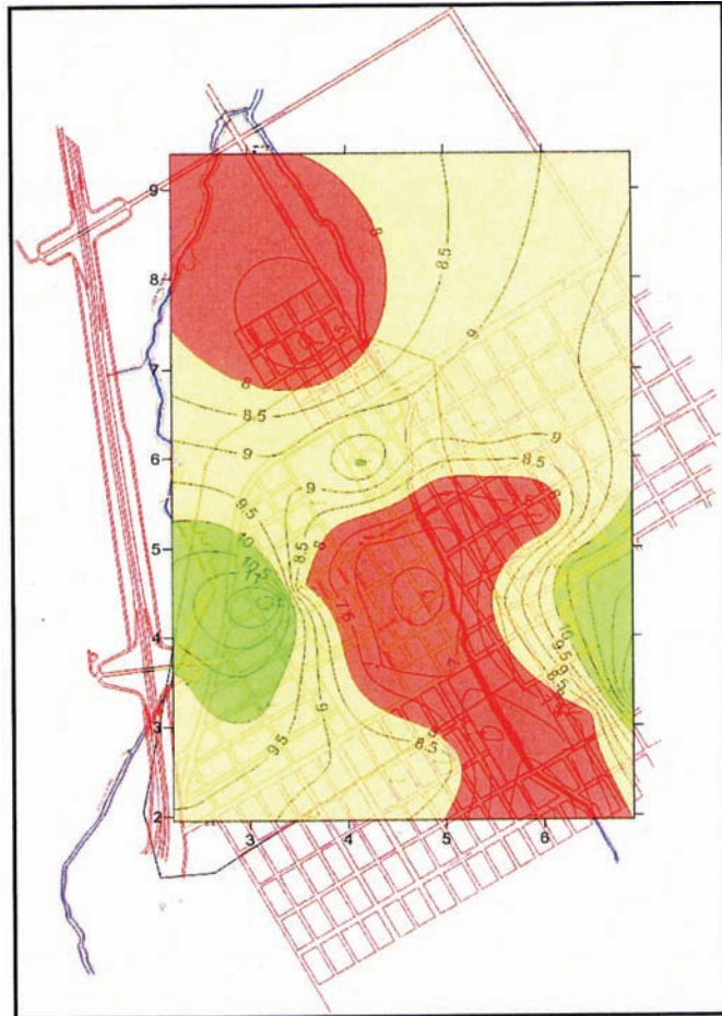
Curva de Isoresistividades. Profundidad de Investigación hasta 12 metros Fuente: SEV. Estudio de Suelos e Hidrología Subterránea. Informe N° 2 Geofísico. Consultora Demison S.A.
